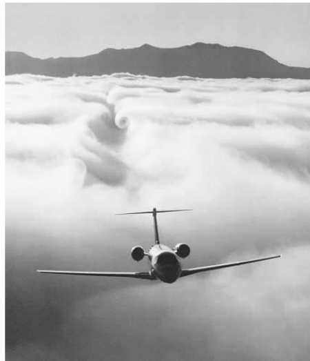
Фиг. 2.9. Фотография на смутена зона (попътна следа от крайни вихри) след самолет.
