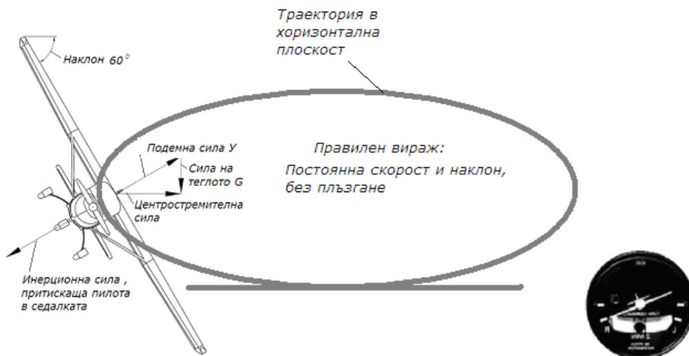
Фиг. 5.12. Сили, действащи на самолета при вираж с наклон от \gamma=60^\circ ; правилен вираж - без изменение на скоростта и без плъзгане.
