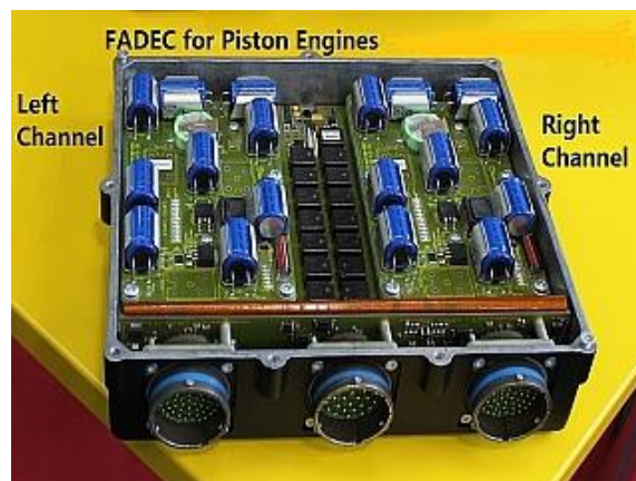
Фиг. 6.12. Блок на цифрова система за управление на бутални двигатели.
