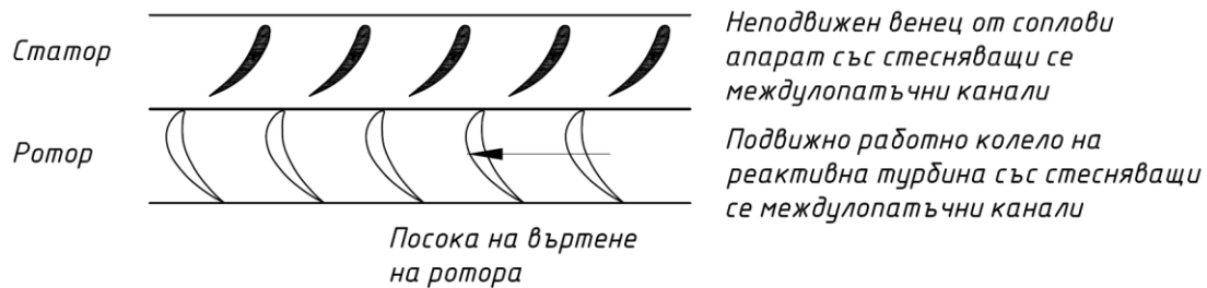
Фиг. 6.7. Схема, обясняваща работата на многостепенна осева реактивна турбина.
