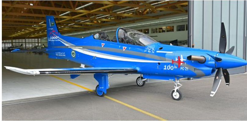
Фиг. 6.9. Самолет "Pilatus PC-21" с ТВД "Pratt & Whitney Canada PT6A-68B с 1200 kW (1600 к.с.).
