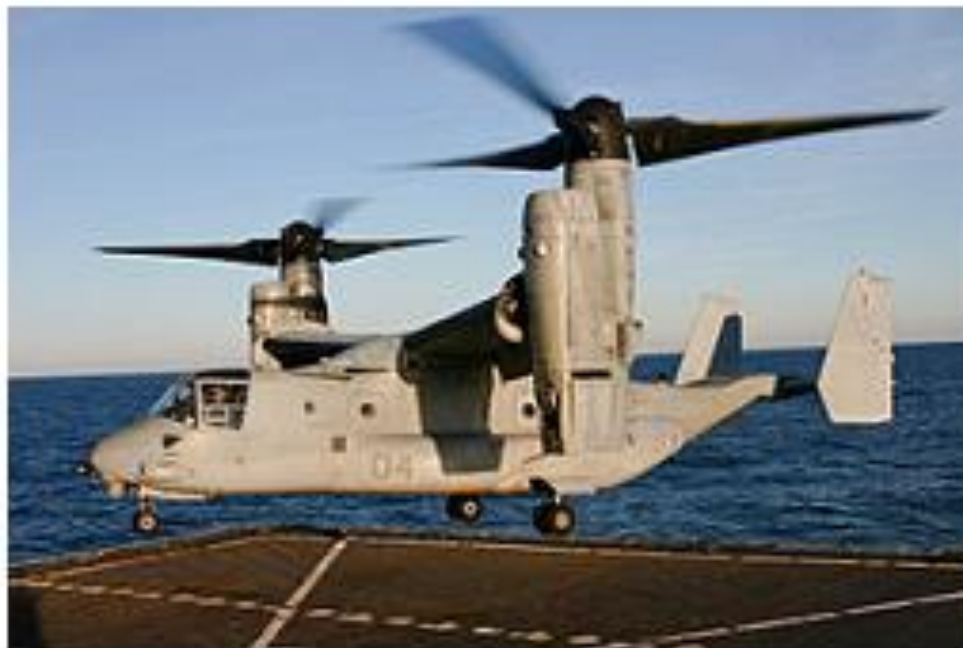
Фиг. 7.12. Вертикално излитане от палуба на V-22 Osprey.
