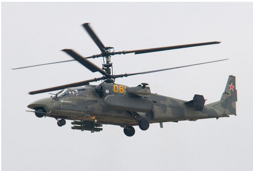
Фиг.7.2. Хеликоптер със съосна схема на носещите витла Ка-50.
