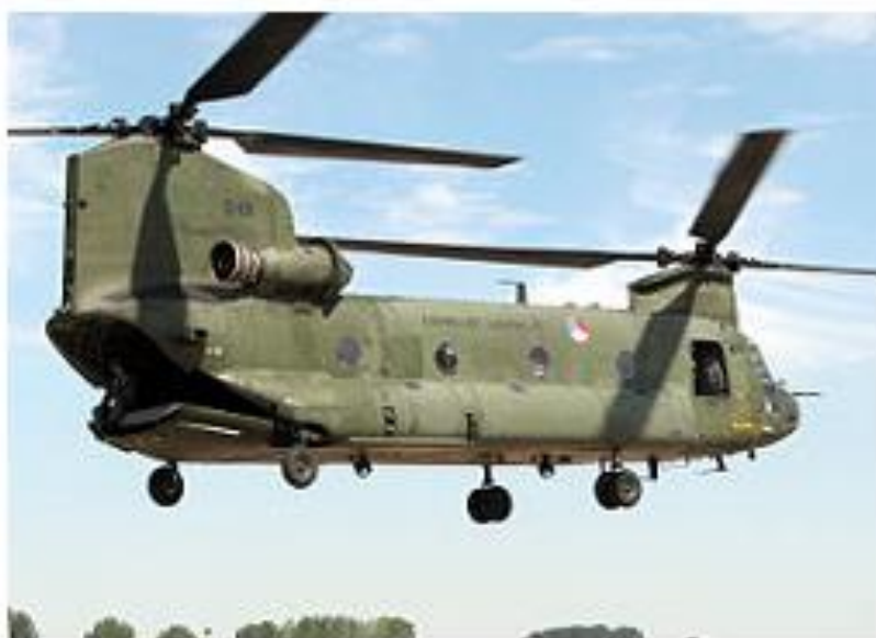
Фиг.7.3. Хеликоптер CH-47D Chinook – двувитлова надлъжна схема.
