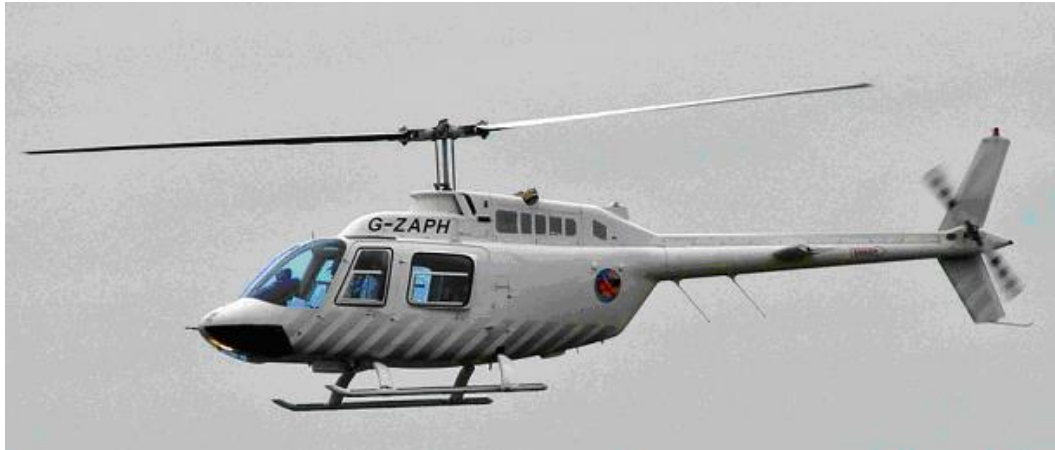
Фиг. 7.1. Хеликоптер Бел-206 едновитлова схема с двулопатно носещо витло.
